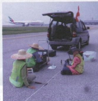
Proses pengukuran lapangan di tapak menggunakan kaedah SASW.
