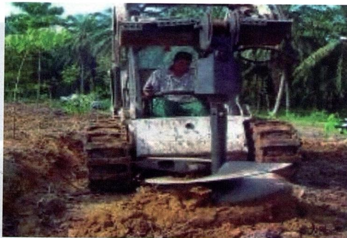
Penyediaan lubang tanaman dengan menggunakan pemuat kemudi kelincir.
