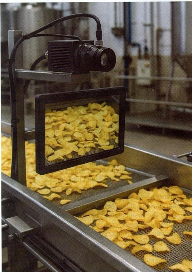
Sistem pemeriksaan automatik terhadap tekstur, warna dan bentuk produk.
