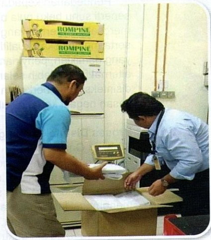
Setiap kotak ditimbang untuk mendapatkan ketumpatan yang hampir setara.
