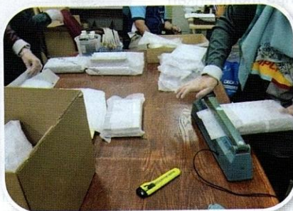
Buku dikedapkan di dalam bekas plastik bagi mengelakkan kontaminasi radioaktif berlaku setelah penyinaran dilakukan.
