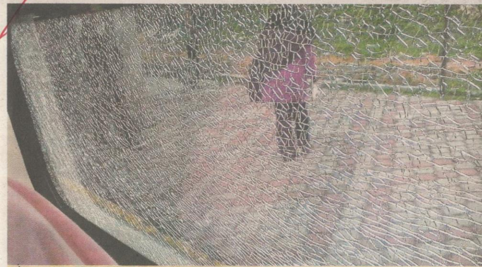
ROSAK...cermin sisi penumpang sebuah tren MyKomuter yang retak selepas terkena lontaran batu.
