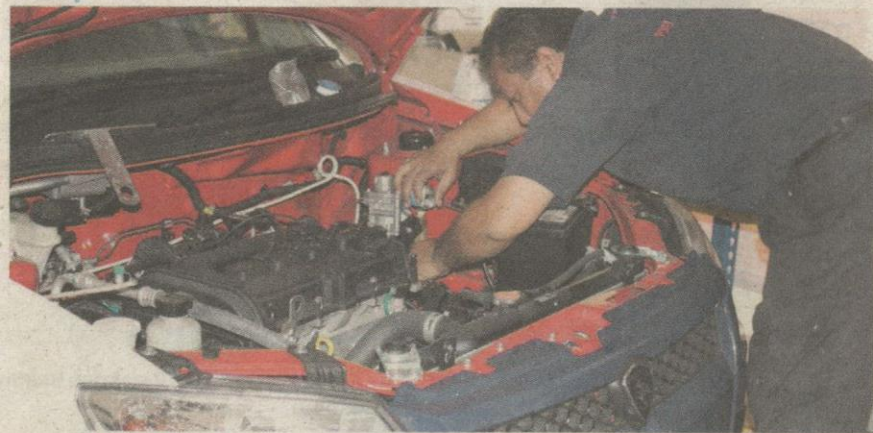
Proses pemasangan NGV pada kereta model Proton Saga.
